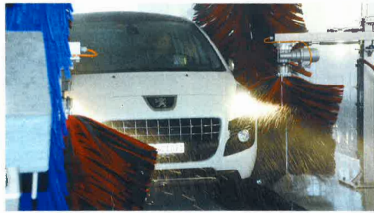
Dank Textilwalzen wird die Oberfläche noch schonender gewaschen.
