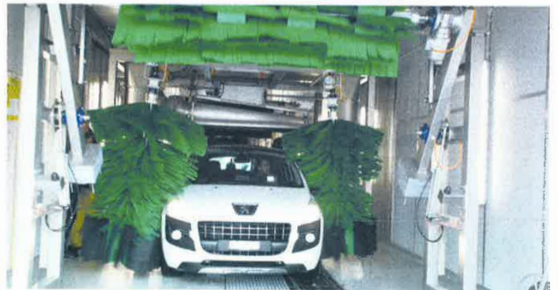
Bei der PREMIUM-Wäsche kommt zur Gebläsetrocknung eine textile Nachrocknung dazu.
